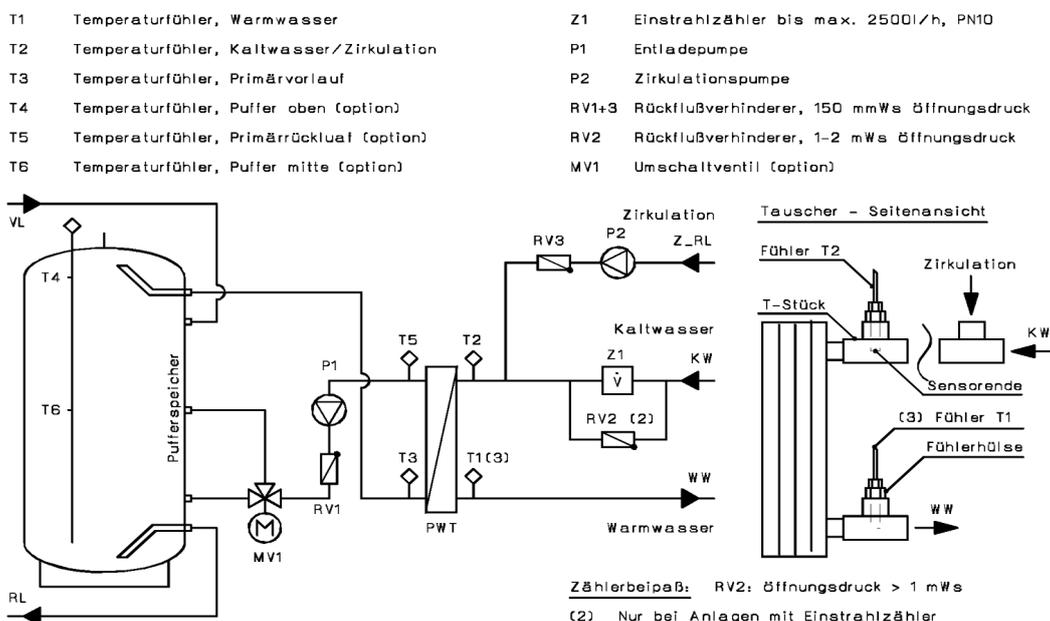
**Achtung:** Zur Verhinderung von Schwerkraftzirkulation ist der Wärmetauscher möglichst tief zu montieren !
