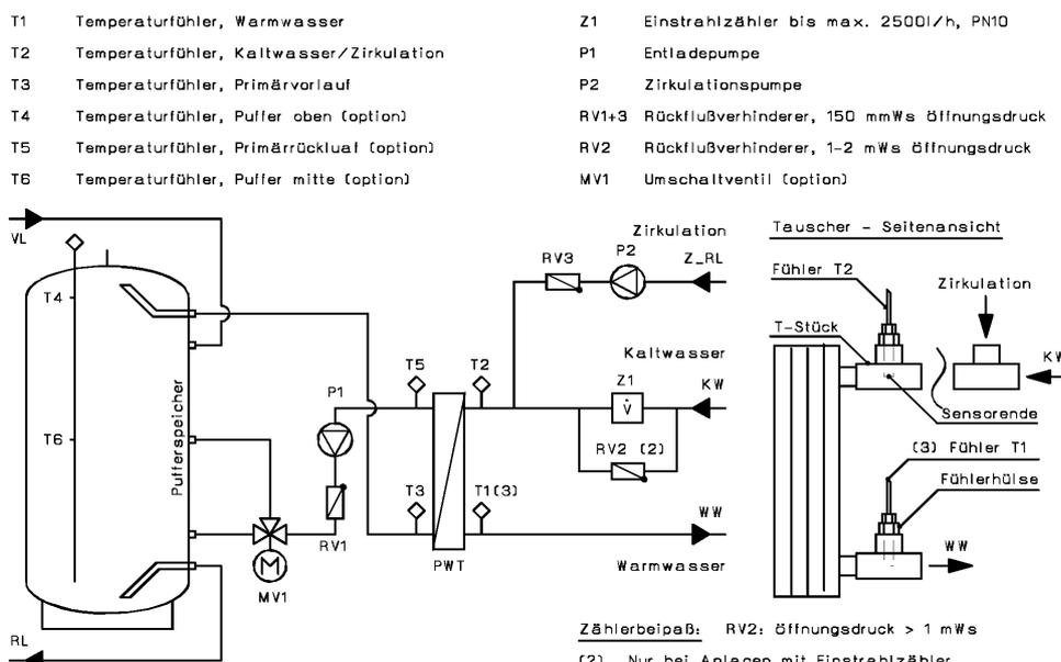
**Achtung:** Zur Verhinderung von Schwerkraftzirkulation ist der Wärmetauscher möglichst tief zu montieren !
