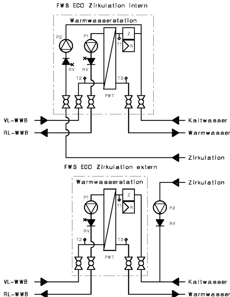
**Achtung:** Zur Verhinderung von Schwerkraftzirkulation sind die Frischwasserstationen möglichst tief zu montieren !
